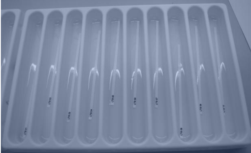
Figure 8: bandelettes placées dans les puits
