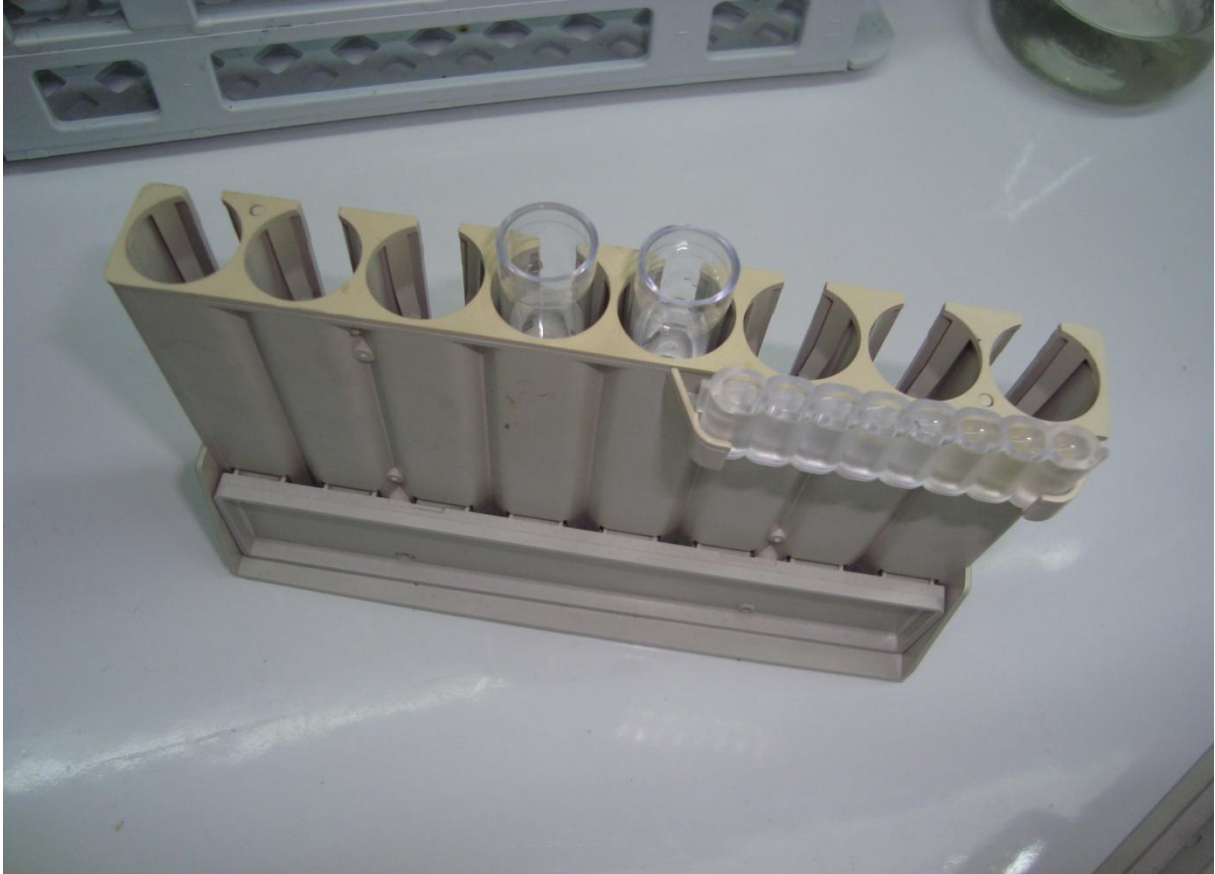
Figure 21 : Portoir des tubes primaires de sérums et une barrette de dilution pour analyse sur Capillarys®
