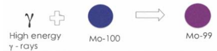
Figure 68 : Production du Mo-99 à partir du Mo-100 [96]
