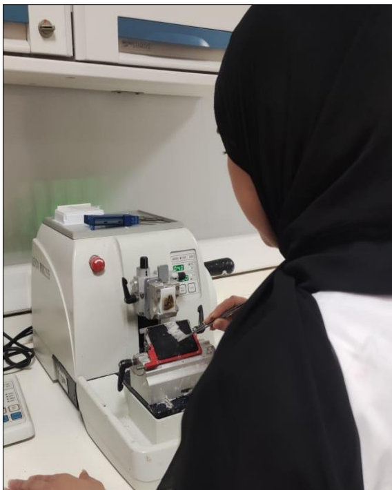
Figure 13 : Réalisation des coupes au microtome.
