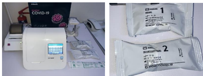
Figure 30: Automate et cartouches de réactifs ID NOW COVID-19.
