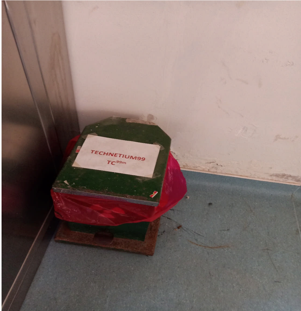
Figure 16 : poubelle plombée pour recueil des déchets solides de ^{99m}\text{Tc}
