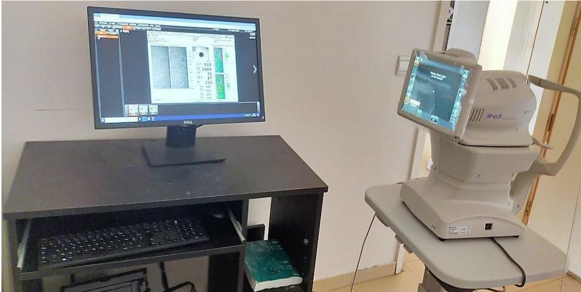
Figure 8 : Appareil de microscopie spéculaire relié au logiciel sur ordinateur (Hôpital des spécialités de Rabat)
