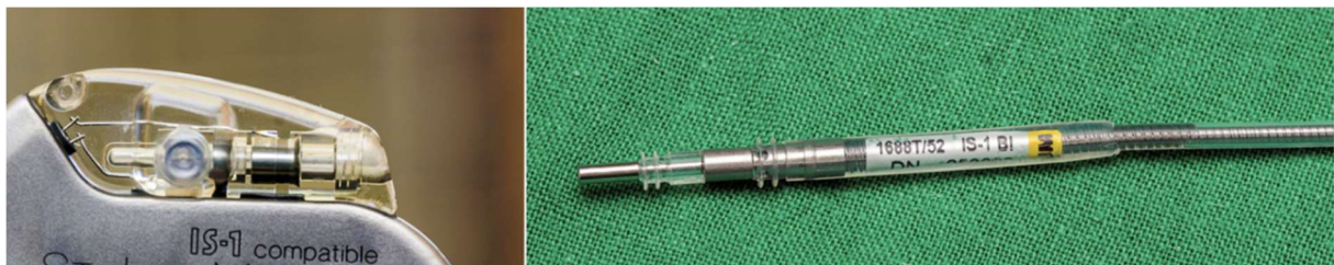
Figure 3: Connecteur IS 1 (norme internationale pour connecter les sondes au stimulateur à visée anti bradycardie) (83)
