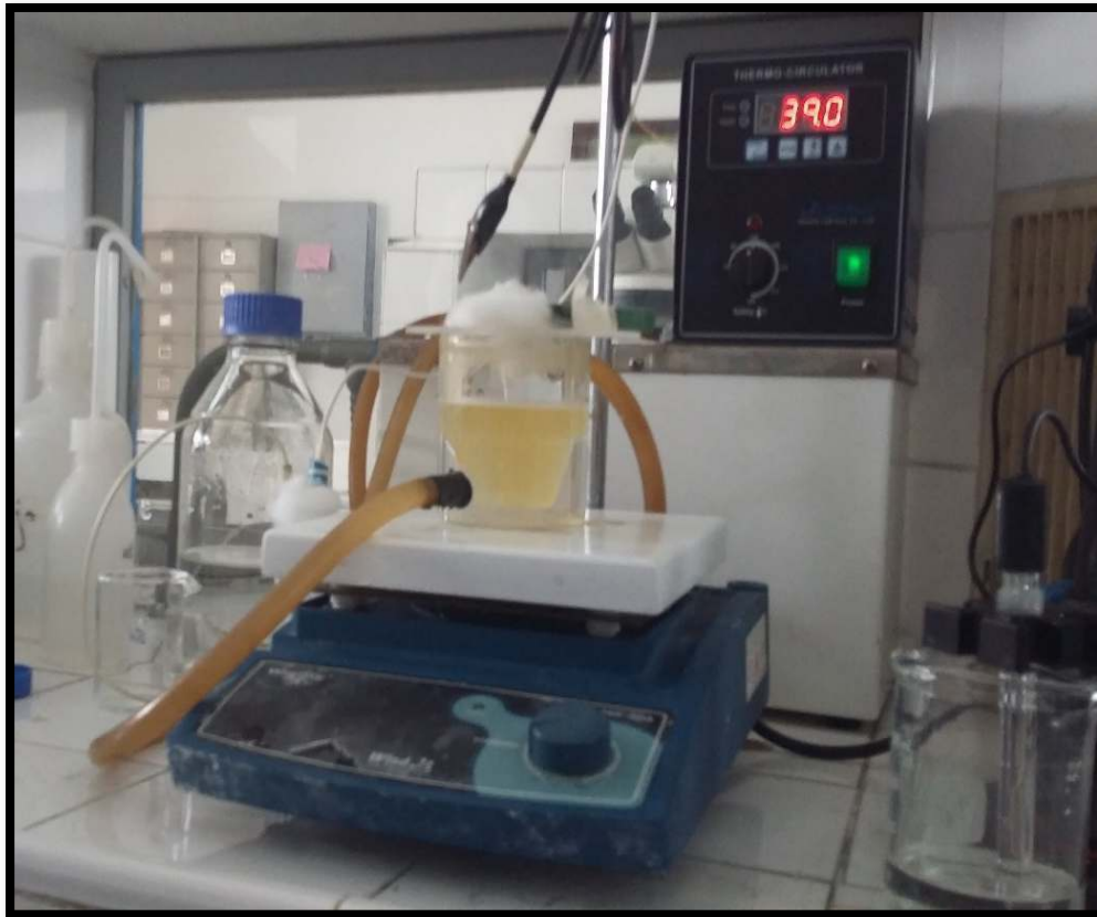
Figure 40 : Cellule électrochimique spécialement adaptée aux études de la biocorrosion. (Laboratoire des Matériaux, Nanotechnologies et Environnement faculté de science, Rabat)
