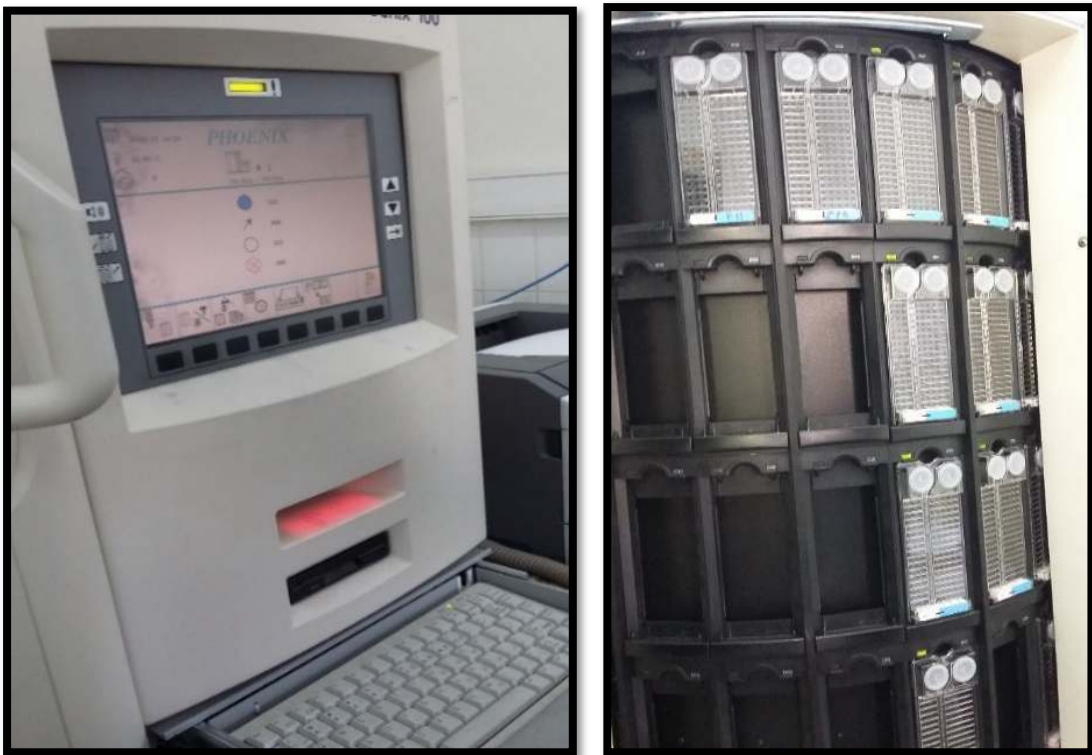
Figure 23 : Photo de l'automate Phoenix qui fait l'identification et l'antibiogramme des germes. (Laboratoire de Microbiologie hopital Ibn Sina. Rabat)
