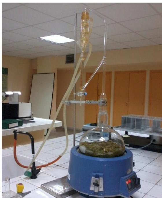
Photo 3 : Montage d'Hydrodistillation de la plante (Clevenger)
