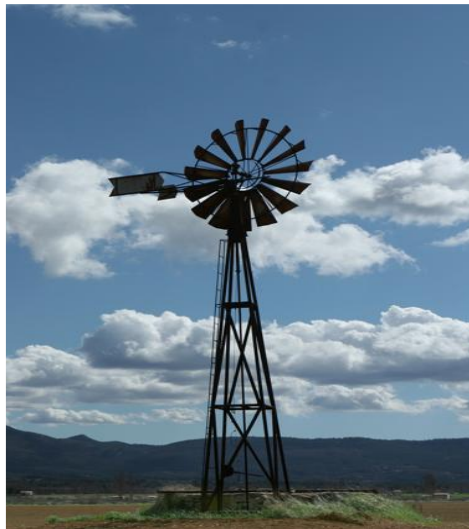
Fig. I. 7: Turbine à rotor multi-pale
