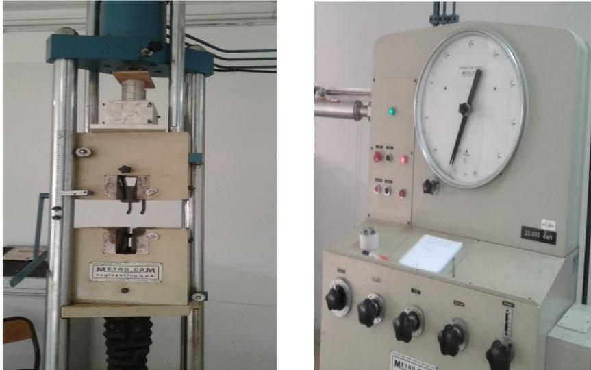
Figure 4-9 : Compactage des briques dans une presse hydraulique
