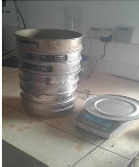
Figure 4-7 : Série de tamis pour l'analyse granulométrique
