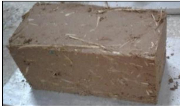
Figure 3-1 : Brique de terre stabilisée par la fibre paille
