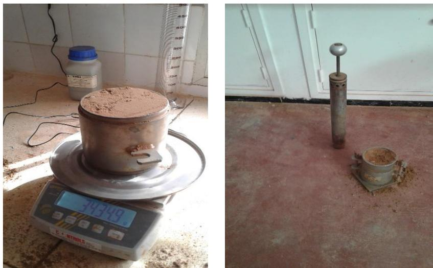
Figure 4-6 : Dispositif de l'essai de Proctor
