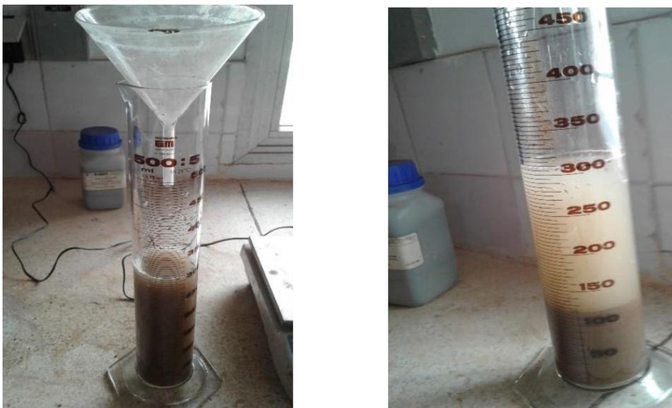
Figure 4-2 : Essai permettant la détermination de la masse absolue du matériau
