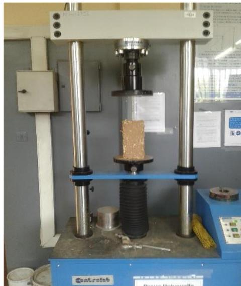
Figure 4-10 : Essai de compression simple à la machine CBR
