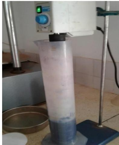
Figure 4-5 : Appareillage permettant la réalisation de l'essai au « bleu de méthylène »
