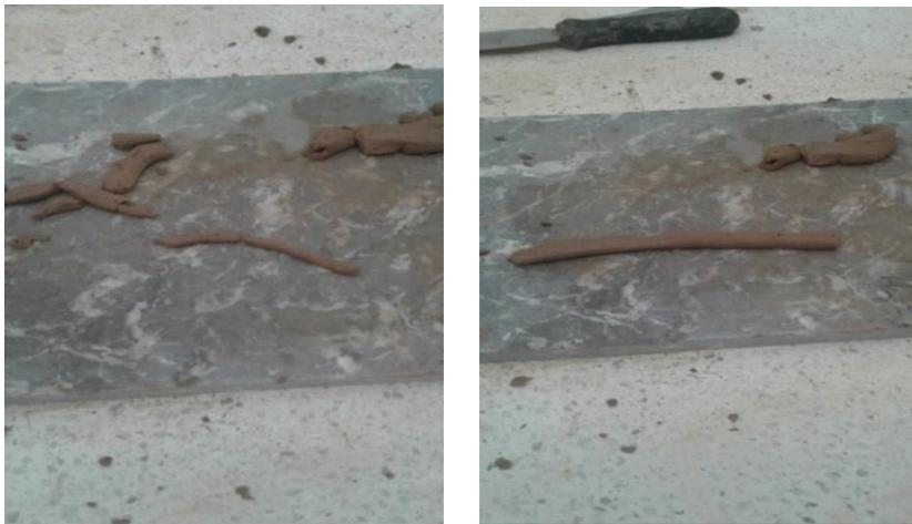
Figure 4-4 : Limite de plasticité au rouleau
