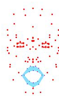
FIGURE 1-16 – Ensemble de 121 points détectés et enregistrés à l'aide de la caméra Kinect
