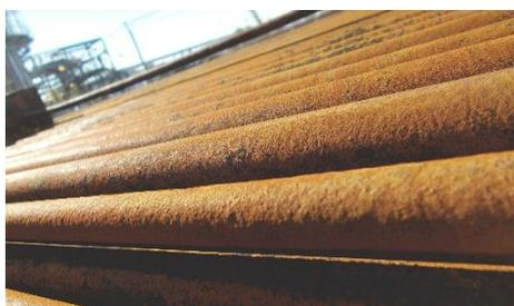
**Figure 83** : Corrosion généralisée.
