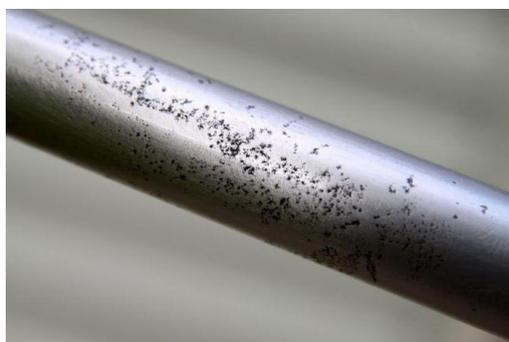
**Figure 86** : Corrosion par piqûres.
