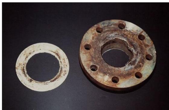
**Figure 85** : Corrosion caverneuse.
