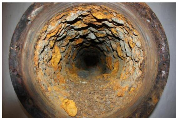
**Figure 89** : Corrosion-érosion.
