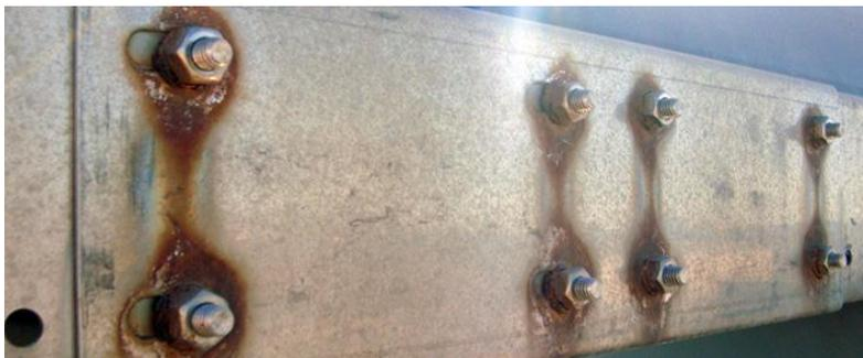
**Figure 84** : Corrosion galvanique.
