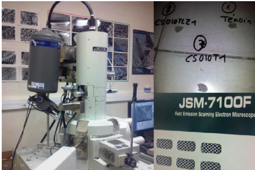
Photo II. 2 : Microscope électronique à balayage Joel JSM-7100F couplé à l'EDS
