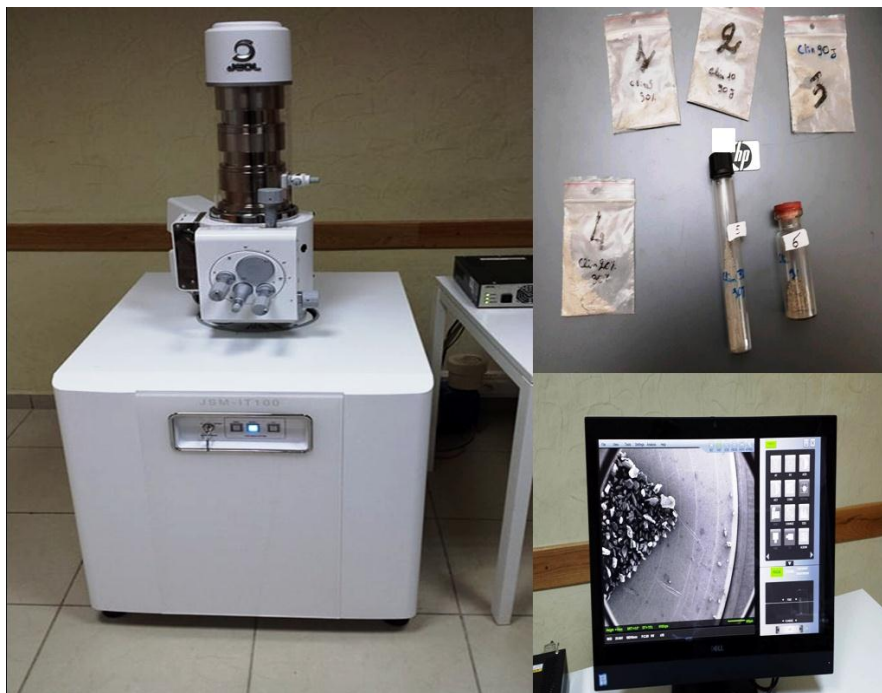
Photo II. 3 : Microscope électronique à balayage JEOL JSM-IT100 couplé à l'EDS
