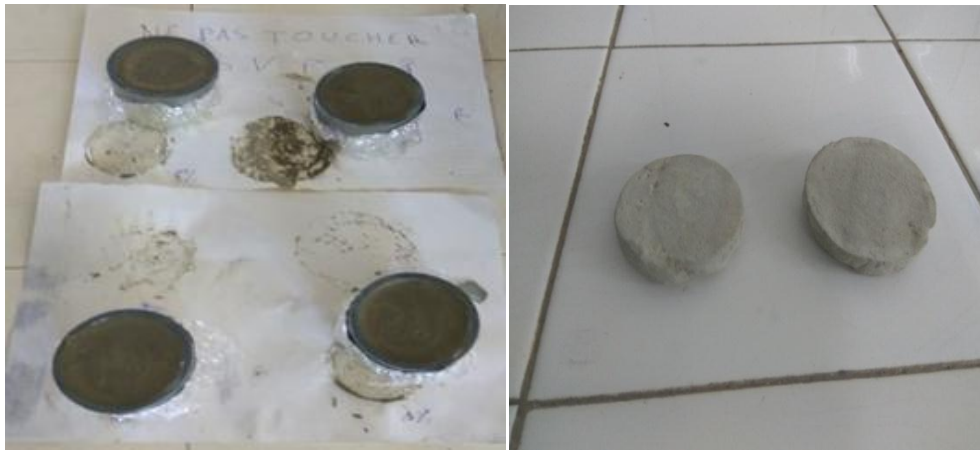
Photo V. 1 : (A) Confection des éprouvettes dans des moules cylindriques et (B) exemple d'échantillons finis
