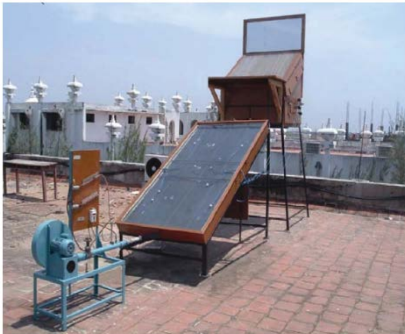
Figure I- 12: Séchoir solaire indirect à convection forcée et à déshydratant
