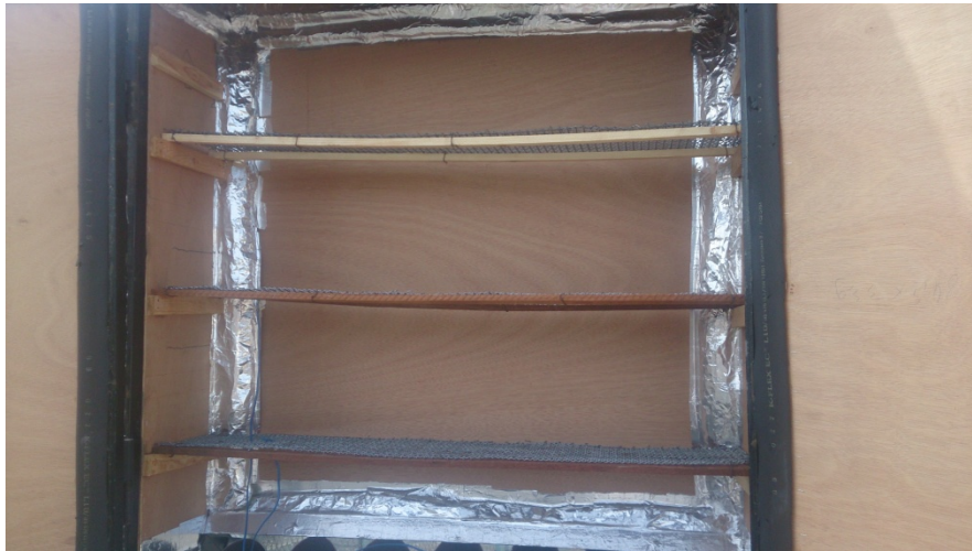
Figure III- 11: Chambre de séchage isolée
