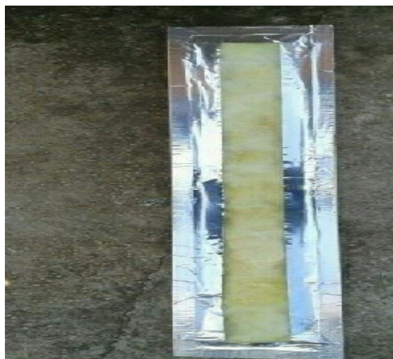
Figure III- 10: Support en contreplaqué remplis avec la laine de verre
