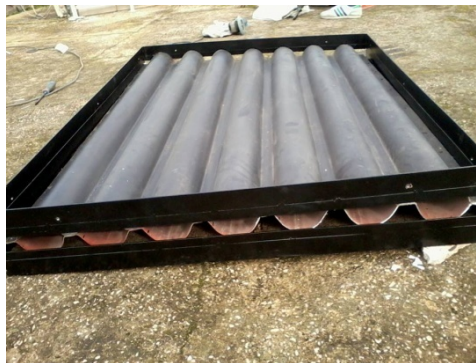
Figure II- 23: Emplacement de l'absorbeur ondulé
