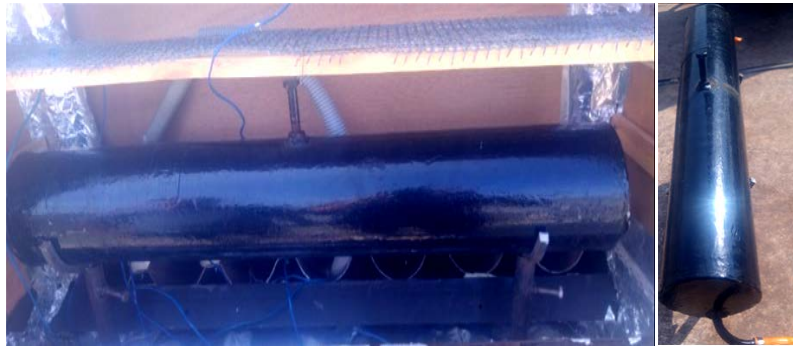
Figure III- 30: Réservoir de stockage d'eau
