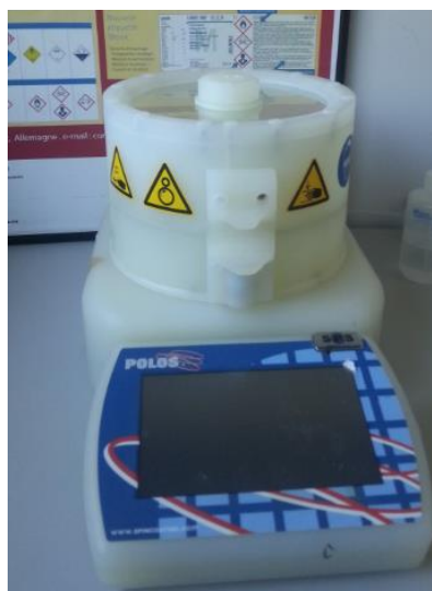
Figure II.11. Technique de Spin-coating utilisée au cours de ce travail (Spin-coater type spin150)
