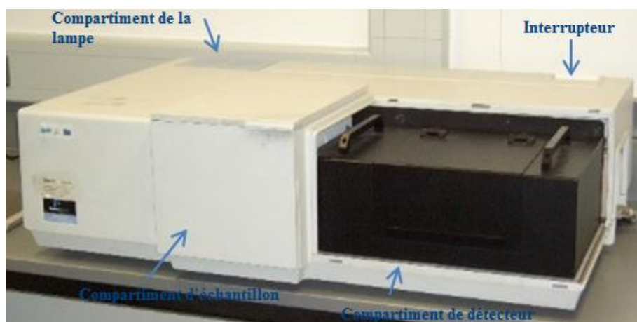
Figure II.18. Le spectrophotomètre UV/Vis/NIR (Perkin Elmer Lambda 900) utilisé au cours de ce travail.
