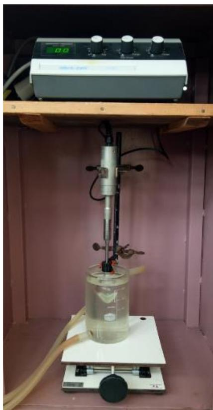
**Figure 33 :** Montage de la sonde ultrasonique
