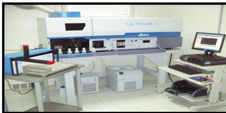
Figure II. 16. Spectrométrie d'Emission Atomique ICP Ultima2 Jobin Yvon (UATRS-CNRST).
