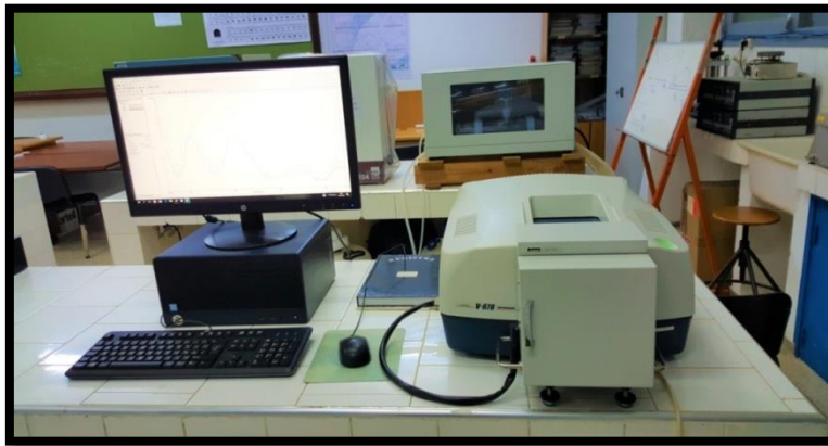
Figure II. 11. Spectrophotomètre UV–Vis-NIR (modèle Jasco V670).
