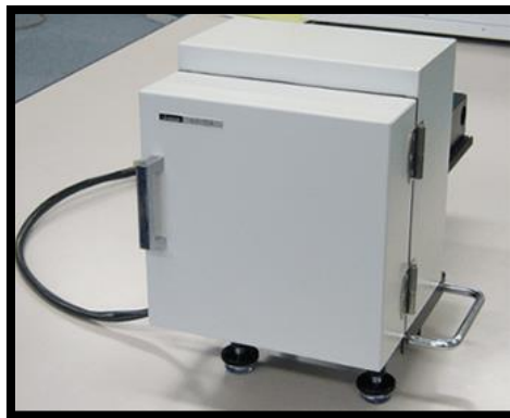
Figure II. 12. Sphère d'intégration de 150 mm (modèle ILN-925).
