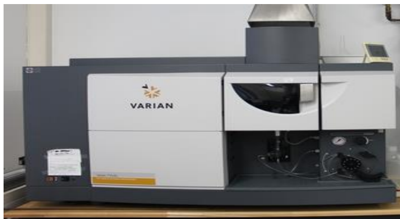
Figure. 3 : Le spectromètre d'ICP-AES 715 de type VARIAN
