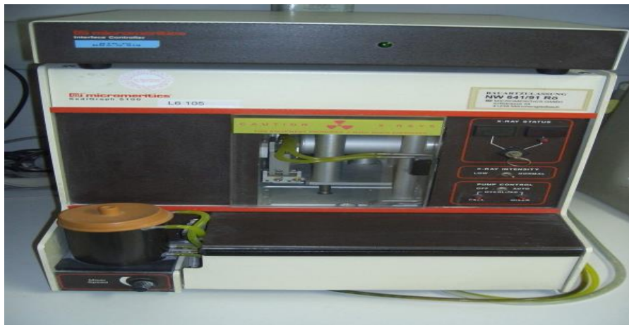
Figure. 4 : Le SediGraph5100 pour la détermination du diamètre moyen
