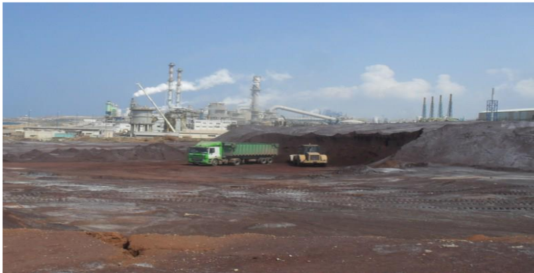
Figure. 7 : Opération d'enlèvement de la cendre de pyrrhotite par des industries cimentières (Photo prise d'une brochure de l'OCP)
