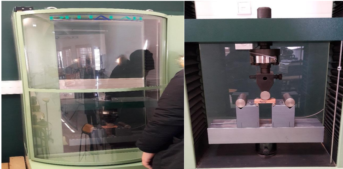
Figure. 10 : Essai de la résistance à la flexion sur trois points
