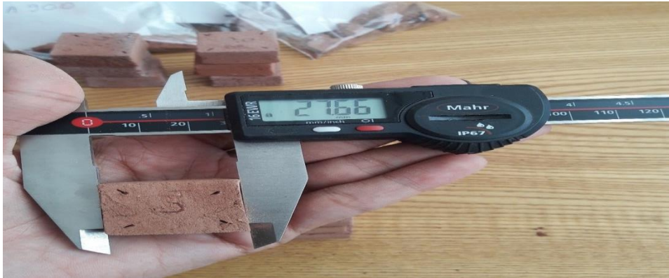
Figure. 8 : Exemple de mesure du retrait/expansion des briques après traitement thermique.
