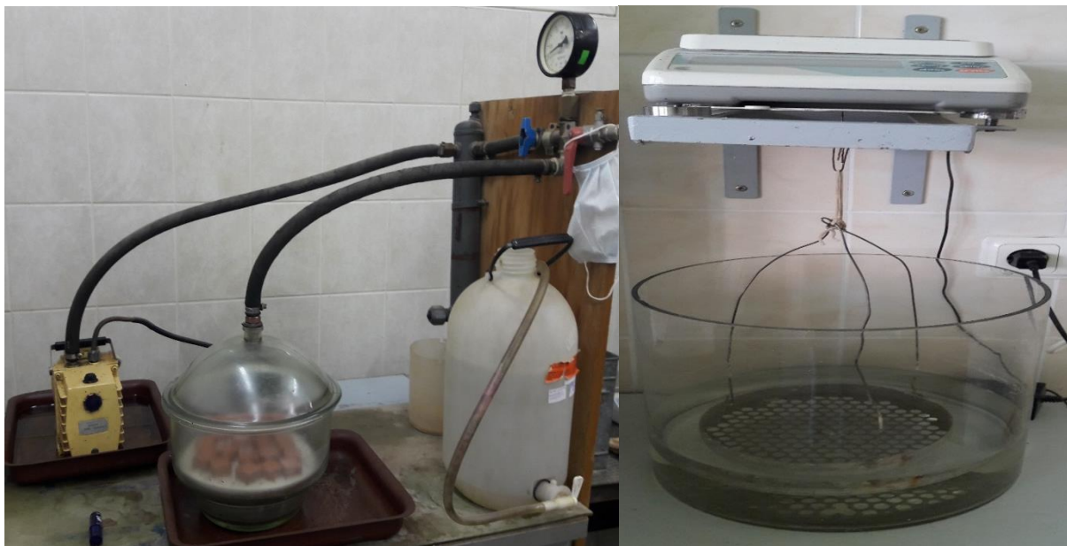
Figure. 9 : Montage de la méthode de saturation sous vide
