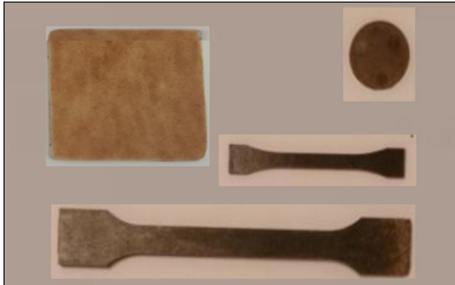
Figure III-11 : Pièces produites par la presse à injecter
