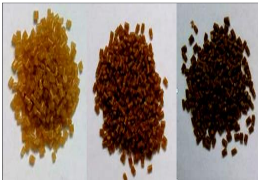
Figure III-6 : Granules produites par la technique d'extrusion
