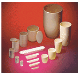
Figure. II. 4 Creusets en céramiques réfractaires ( T_{fusion} > 2000^{\circ}C ) utilisés pour le traitement thermique
