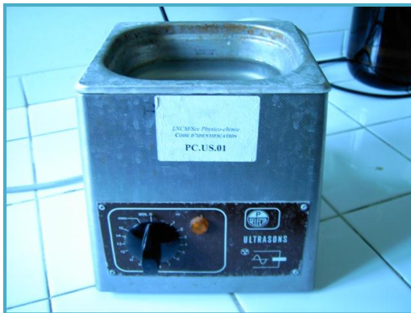
Photo 12 : Appareil d'ultrason [Photo du LNCM].
