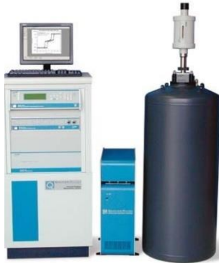
Figure II.21 – Photographie du PPMS équipé de la tête VSM pour des mesures d'aimantation
