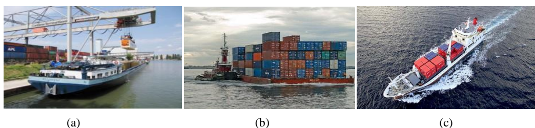
Figure I-3. (a) Automoteur, (b) barge, (c) caboteur fluvio-maritime (Source : www.meretdesign.fr )
