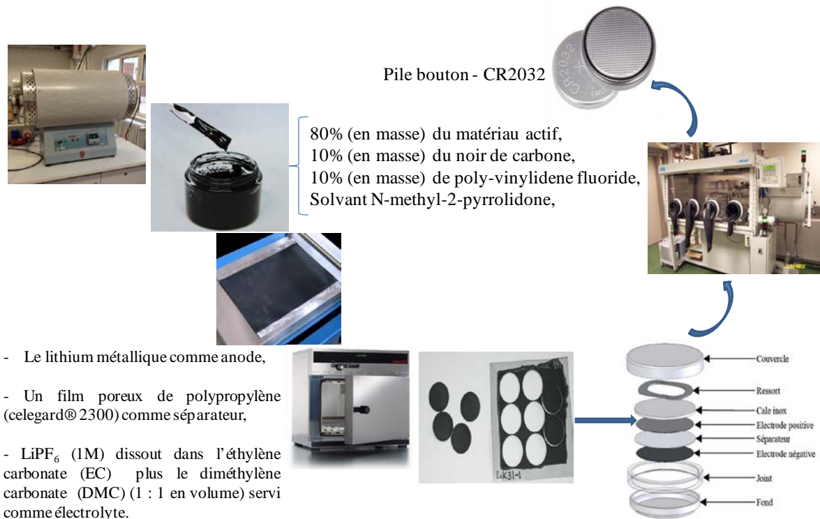
Figure II.7: Etapes de préparation, d'assemblage et configuration de la batterie (pile bouton)
