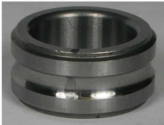
FIGURE 4.2 – Défaut de bague interne.
