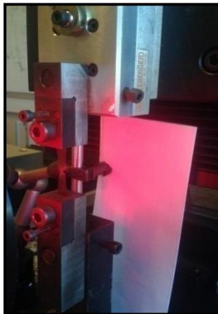
**Figure II. 11 : Machine de l'essai de traction utilisée dans notre étude.**
