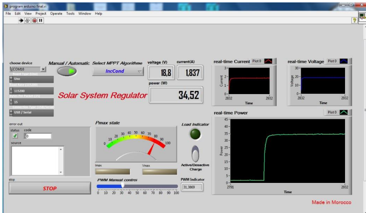
Figure I-22: Interface graphique de contrôle du système MPPT
