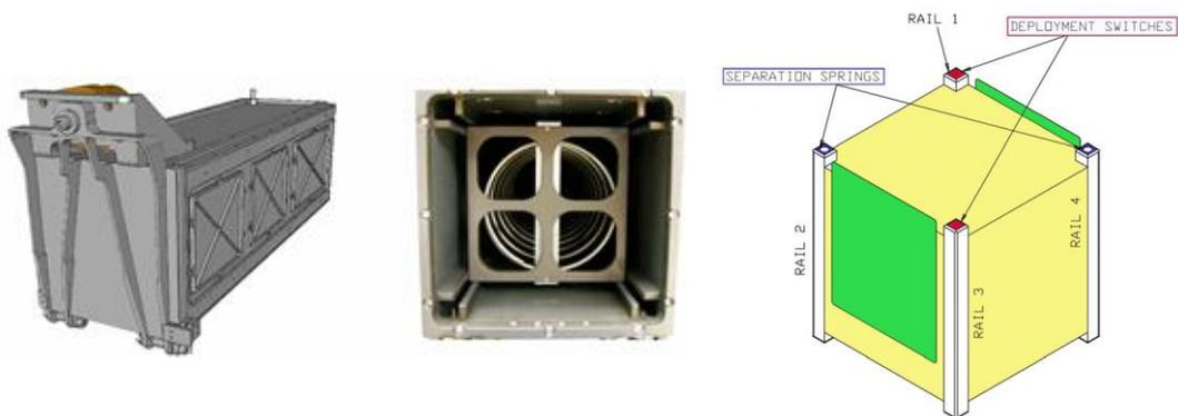
**Figure 5-16** : Vue perspective du P-POD et des ressorts de séparation [10]
